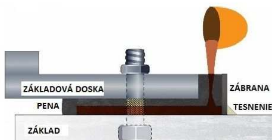
Obrázok 5 – Produkt Belzona®7111 vyliaty tenkým prúdom.
