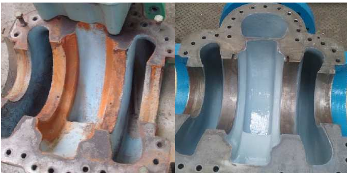
Teleso čerpadla natreté pre ochranu a zlepšenie účinnosti
