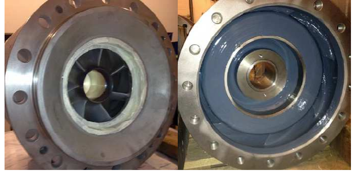
Vnútrotný náter komôr čerpadla morskej vody
