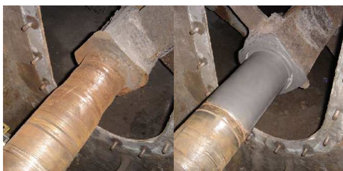
Hriadeľ obnovený do pôvodného profilu na mieste prevádzky
