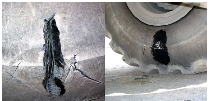
Pneumatika opravená na mieste
