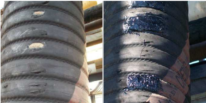
Opravená sacia a výtlačná hadica oleja
