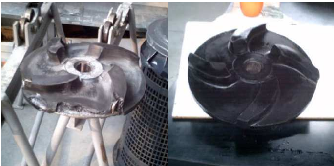
Renovované vážne poškodené obežné koleso
